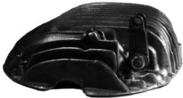
Das Bild zeigt den Ventildeckel für die Motoren der ersten (und teilweise auch der zweiten) Ausführung. Der Bowdenzug für den Ventilausheber kommt hierbei von vorne. Die eingegossene Nummer lautet 802 023 .
